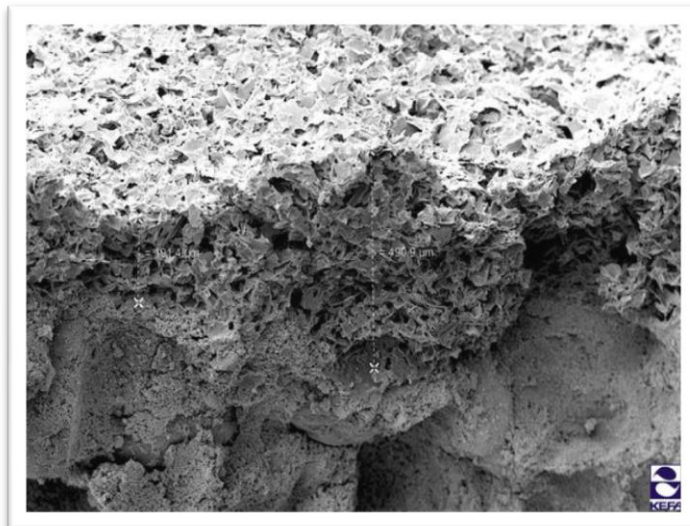
mikroskopische Aufnahme der KefaTherm-Oberfläche
